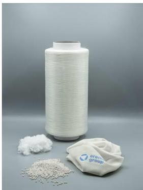
Im Bild: Faserabfall aus der Filamentfaserproduktion wurde im EREMA Fasertechnikum zu hochqualitativem Regranulat recycelt. Daraus wurde wieder mit Filamenttechnologie eine Faser mit 3 dtex ausgespinnen und diese wieder zu Gestrick für Kleidung oder technische Textilien weiterverarbeitet. (Foto: EREMA)
